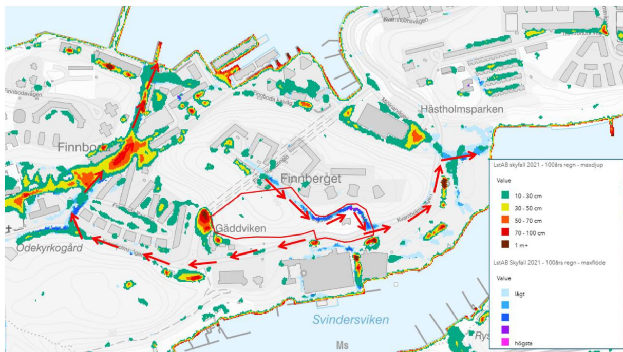
Figur 17. Bild som visar en karta över beräknade maximala vattendjup. Skyfallsanalys Länsstyrelsen (2026). Kartunderlag för klimatanpassning. Detaljplaneområdet Uttblicken och Förmansbostaden markerat i rött. Pilar indikerar de två större avrinningsvägarna.
