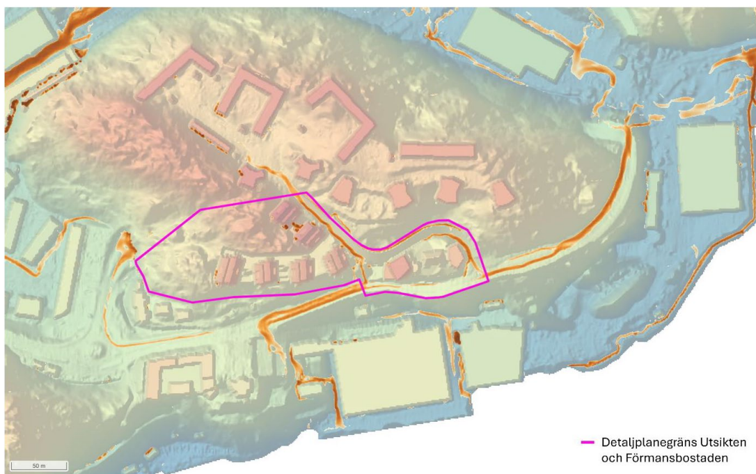
Figur 43. Bild som visar beräknade maximala vattenflöden (Flux) vid ett modellerat 100-årsregn med klimatfaktor. Planerad situation, scenario 1.
